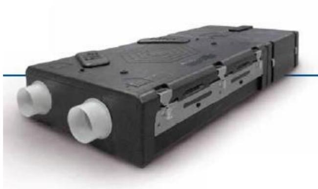
**Figura 10** - unità centrale tipo "MAICO AERA In linea 180" unità centralizzata di estrazione e di immissione aria con recupero di calore ad alta efficienza ad installazione orizzontale, portata massima 180 m<sup>3</sup>/h.
